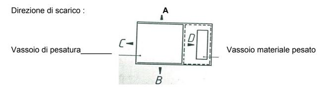
La direzione di scarico del vassoio materiale pesato deve essere variata secondo le istruzioni a pagina 6. Le parti mobili del dispositivo di controllo sono fissate per evitare spostamenti durante il trasporto con l'imballaggio e nastro adesivo, che deve essere rimosso prima della messa in funzione.
